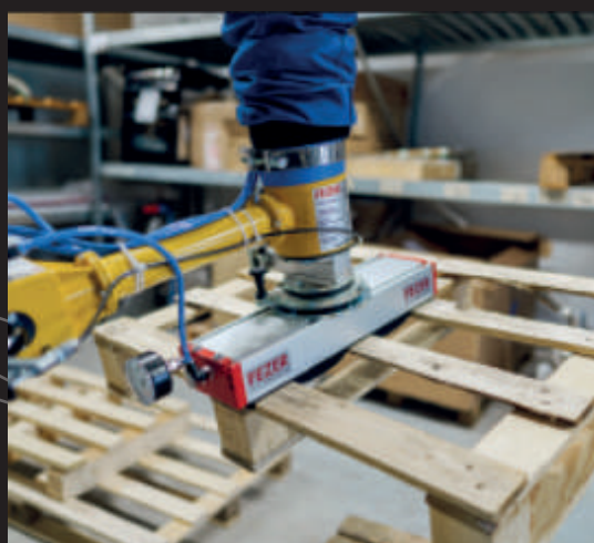
VacuQuickLift VQL Podnośniki tubowe o udźwigu max. 200 kg
