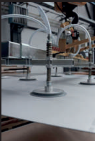
Chwytki do transportu poziomego detali od 80 do 40000 kg
