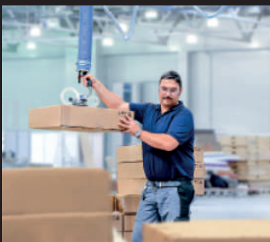
VacuQuickLift VQL Podnośniki tubowe obsługiwane jednoręcznie do lekkich detali
