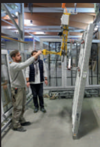
Chwytki do okien o dowolnej konfiguracji i udźwigu max. 650 kg
