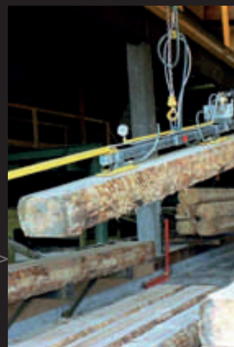
Chwytki do przenoszenia tarcicy o udźwigu max. 1000 kg
