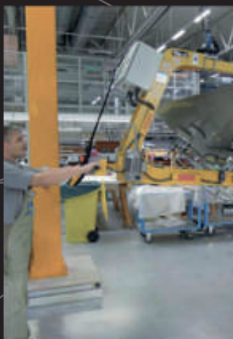
Chwytki z możliwością obrotu o 180 stopni i udźwigu max 2500 kg
