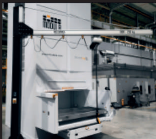
Żurawie słupowe z wysięgnikami aluminiowymi o udźwigu max. 1200 kg
